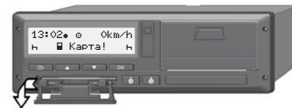
Рис. 11: Откидывание крышки вниз
